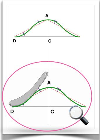
• Tracer une courbe concave remonté à 1cm au point D et passant par le point Descendu à 1cm.
