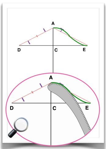
• Tracer une courbe convexe reliant le point descendu à 0,7cm au point A et passant par le point remonté à 1cm.
